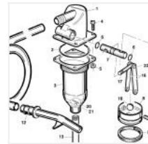
POMPA A TRAVASO PER FUSTI (tubo rig., 100 ml/pomp.)
